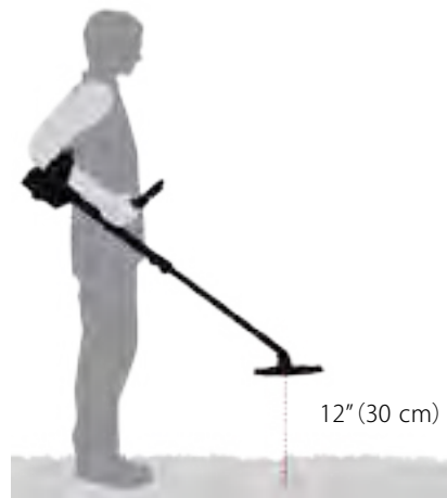
図 17 - ノイズキャンセルのための探知機の正しい位置
