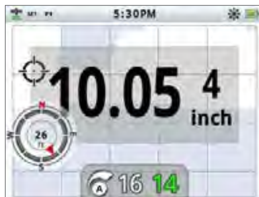
図 33 - 任意のアイテムを表示している探知スクリーン
